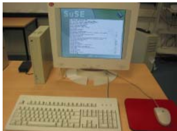
Bild 1: Beispiel eines Mini-PCs mit TFT-Display sowie Tastatur und Maus als Thin-Client
